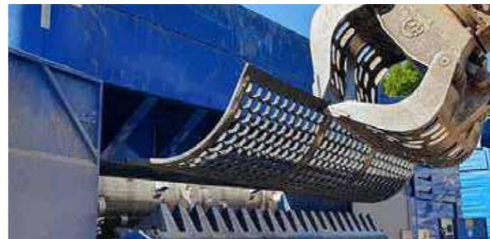
Definición del grano final mediante cestas tamizadoras y ranura de corte
