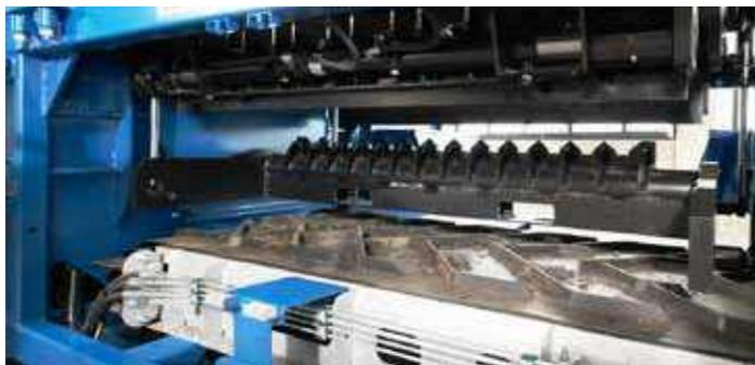
Definición del tamaño de grano final mediante varias barras post-rotadoras y cestas de tamizado
