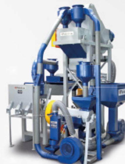
TRILLADORA DE MICROLOTES - C2DPRC MICROLOT MILL - C2DPRC Conjunto de trilla, pulido y selección. Combined set to hull, polish and size grade. capacidad / capacity : 300 kg/h (café almendra / green coffee)
