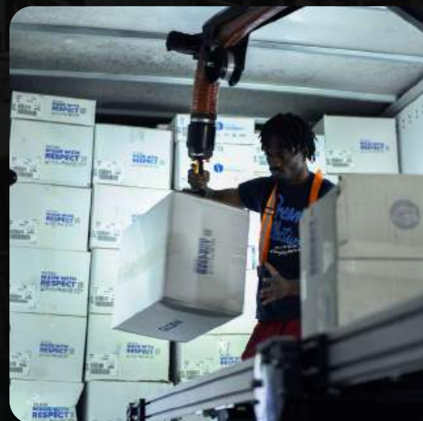
Descargador de contenedores
