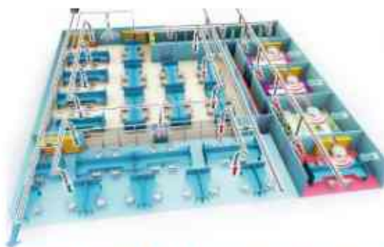
Redes de flujo de aire para laboratorio y oficinas
