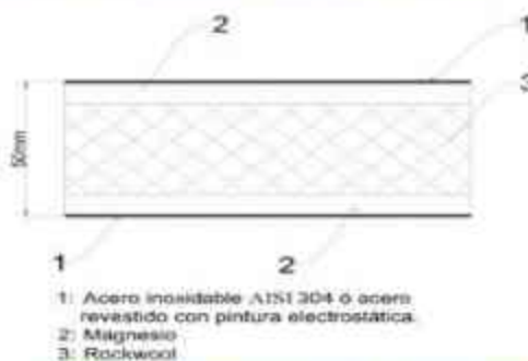
Composición interna de un panel de pared
