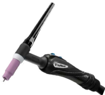
EXPERTIG 18 - 320Amp DC - 270Amp AC @100% - TSK 50 - 1/4 G - REFRIGERADA POR AGUA. Diametro de 4 y 8 metros.
