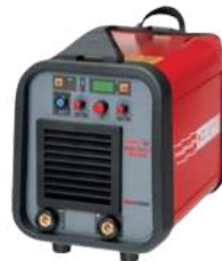
602150100 EQUIPO - INVERSOR - REVESTIDO - MMA/TIG - 10-230 AMP - TRIFASICO - 220/440 VOL - SOUND MMA 230T - MV - CELULOSICO - CEBORA - ITALIANO
