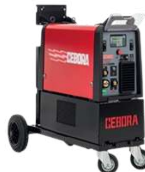
602160020 EQUIPO - MULTIPROCESO - INVERSOR MIG-MAG - TIG DC - MMA - 10-330 Amp - 230Vol - SYNSTAR 330 TC - COMPACTO - CEBORA
