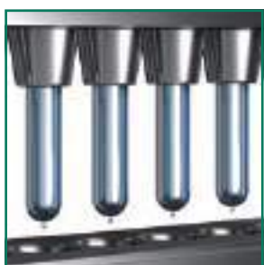
1 Estación de Inyección de Preforma
