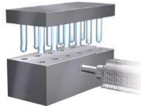
Sistema de cierre vertical que garantiza preformas de la más alta calidad.
