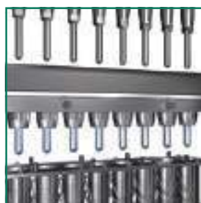
2 Estación de Zero Cooling / Acondicionamiento
