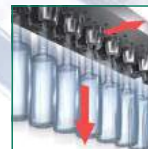
4 Estación de Expulsión de Envases
