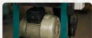
MOTOR DE 1HP 110V 1740 r/min
