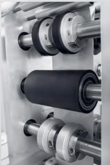
Sistema patentado de precorte interno y externo ajustable con tornillos micrométricos, forman parte de las innovaciones del sistema de apertura monodosis V-Shapes® con una sola mano.
