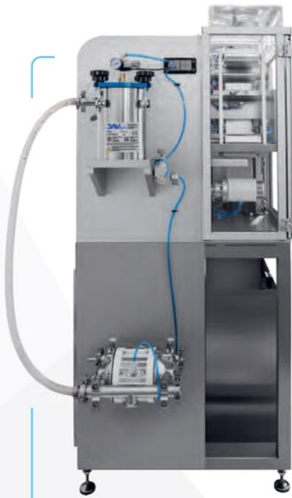
La V-Shapes® PRIME es nuestra máquina de envasado, llenado y sellado de un solo carril. El sistema patentado de apertura de sachets monodosis con una sola mano, permite un rango de llenado de 0,5 ml a 30 ml. Aprovechando las tecnologías de Trojan y SIHL, tenemos la solución perfecta para imprimir trabajos pequeños y medianos.
