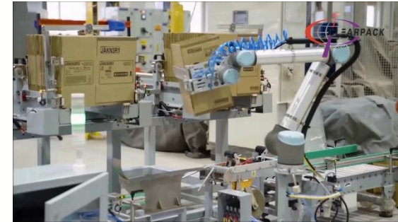
Sistema de armado de cajas
