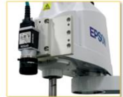
Se muestra el robot Epson G3 SCARA con una cámara móvil montada como parte de la opción Epson Vision Guide
