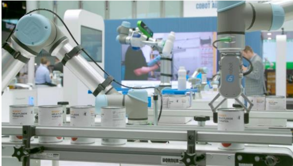
Sistema de empaque para fin de línea
