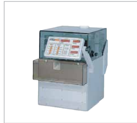
SISTEMA DE CONTROL EN LÍNEA (Peso, espesor y dureza)
