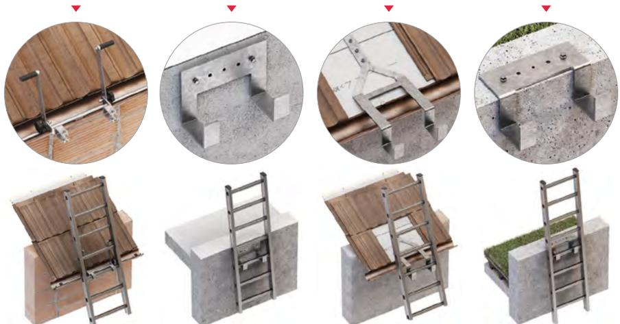
Los **ganchos para escaleras** se han proyectado para evitar que las escaleras portátiles se deslicen lateral y frontalmente. Ideales para usar cuando no existe un acceso interno a la cubierta.
