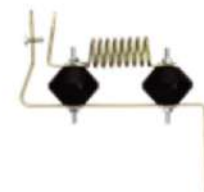
DESVIADOR DE RAYOS
