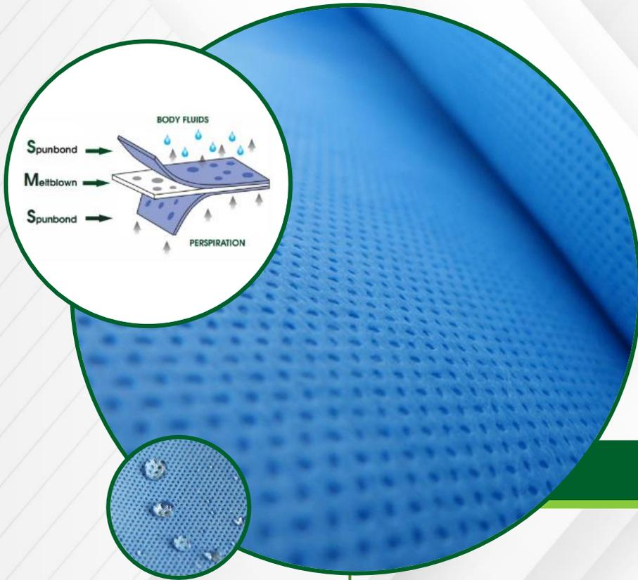
**El SMS es formado mediante aglomeración física, térmica y química de filamentos sin pasar por un telar. Este tipo de tela está conformada por 3 capas de polipropileno; 2 externas tipo Spunbond que cubren una capa de tipo Meltblown en el medio.**
