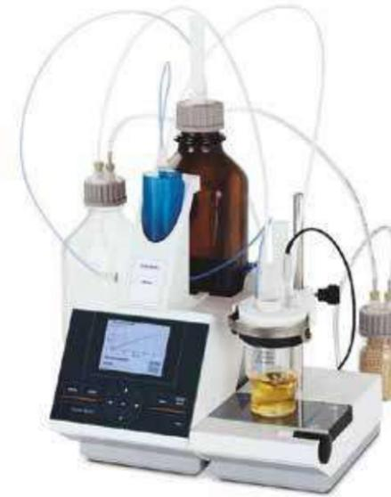
LAB BRANDS brinda soluciones para realizar la determinación de contenido de agua para el método ASTM D4377 Y ASTM 4928, mediante los equipos Karl Fisher 7500 y 7500 trace.
