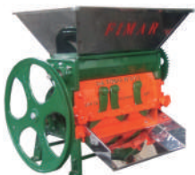
Despulpadora No. 3 1 / 2 Cap. 800 kg/h
