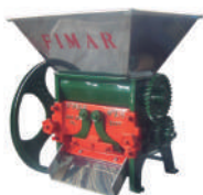
Despulpadora No. 2 1 / 2 Cap. 400 kg/h
