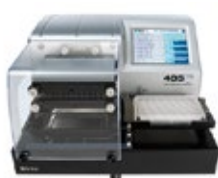
Lavadores de placas
