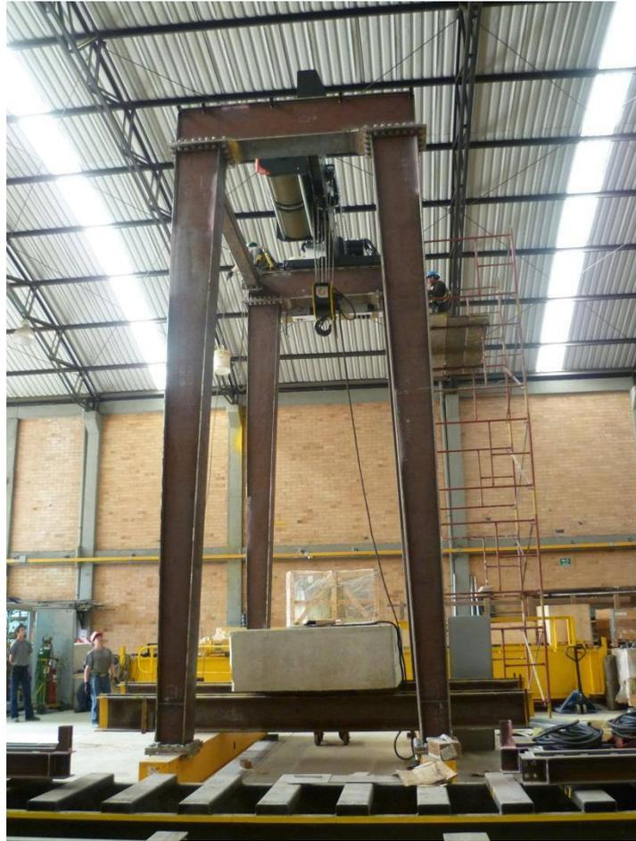
**ENSAMBLE DE PÓRTICO DE 16 TON, PH EL QUIMBO - COMPUERTAS**
