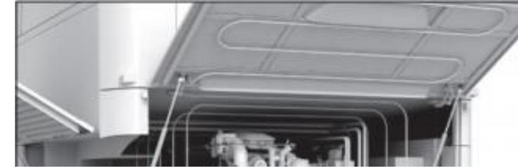
Detecta un incendio y envía una señal a la válvula solenoide que acciona la válvula diferencial de presión especial e instantáneamente inunda todo el compartimento del motor extinguiendo agente.
