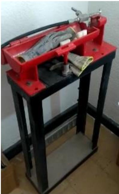
EQUIPO PARA RECARGA DE NITRÓGENO Y CO2 BAJA PRESIÓN
