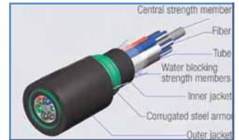
Cables diseñados para planta externa a largas distancias, plantas telefónicas, CATV y comunicación de datos entre otras. Estos cables tienen un diseño de múltiples tubos holgados, se permiten diseños de hasta 36 tubos dispuestos en 3 capas alrededor de un refuerzo central que puede ser dieléctrico o en acero. Se ofrece gran variedad de elementos bloqueadores de agua, chaquetas y protecciones.
