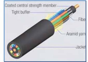
Cables para distancias cortas y medianas para uso interior y exterior protegido, diseñado especialmente para interconexión de cajas de distribución y equipos e instalaciones tanto horizontales como verticales. Estos cables contienen un sub buffer individual por cada uno de los hilos de fibra lo cual facilita la conectorización y da una protección mecánica adecuada manteniendo altos niveles de flexibilidad.
