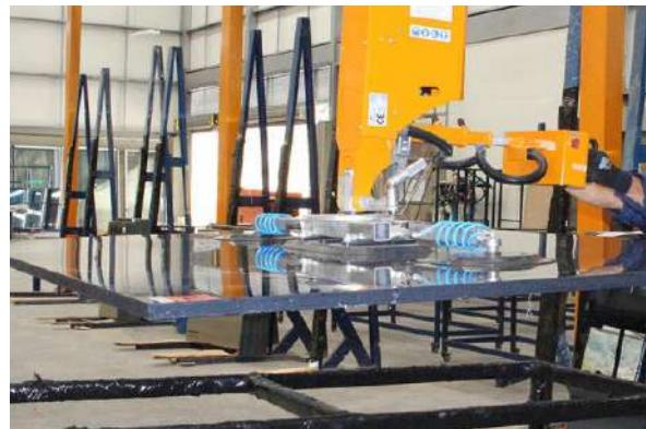
Grúa y Ventosas Eléctricas
