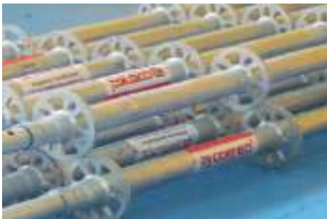
Andamio Multidireccional (Ring Lock)
