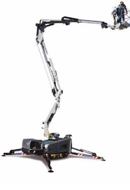
Las plataformas Octopuss, montadas sobre oruga, son equipos livianos y debido a las orugas dan la capacidad de desplazarse en cualquier terreno o moverse sobre cambios de nivel
