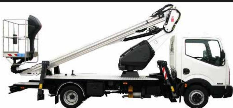
Las plataformas soportadas en camión, popularmente conocidas como camión canasta o brazo montado sobre camión, son equipos livianos, prácticos, de fácil desplazamiento y especialmente diseñados para trabajar en vías públicas. En algunos casos pueden contar con sistemas de aislamiento en canasta para trabajos específicos con líneas eléctricas
