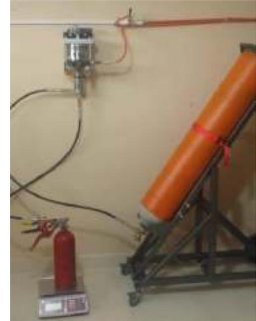
EQUIPO PARA RECARGA DE NITRÓGENO Y CO2 BAJA PRESIÓN
