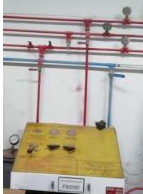
EQUIPO PARA PRUEBAS HIDROSTATICAS
