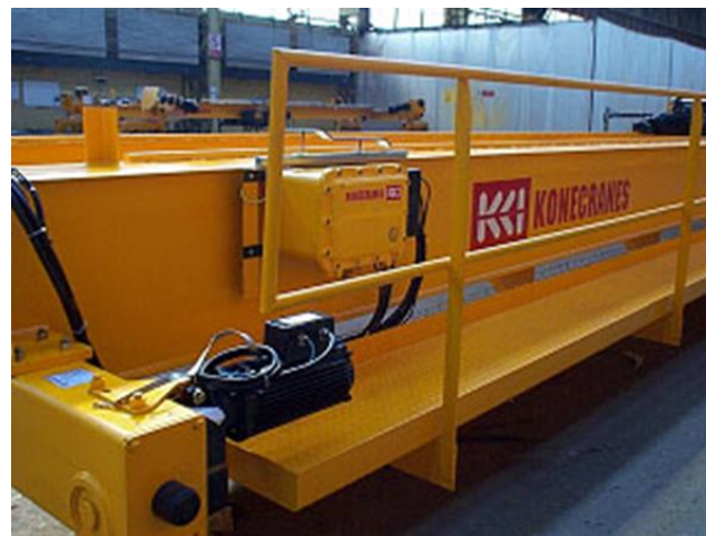
Industria Petroquímica - Puente grúas a prueba de explosión
