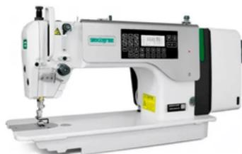
La A8100 aumenta tu productividad y rendimiento al incorporar levanta pie, rematador y cortahilos automático. Los equipos automáticos de ZOJE te permitirán realizar un trabajo de material liviano a material pesado adicional programar funciones para configuración de bolsillería, presillado lineal, multisegmento con motor paso a paso.
