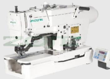
Máquina para ojales con cortahilos y motor incorporado en el cabezal de la máquina, diseñada para coser materiales ligeros y medianos. Equipado con el dispositivo de seguridad que evita que la tela se corte en caso de que se rompa el hilo. Número de puntadas cambiadas por engranajes rectos.
