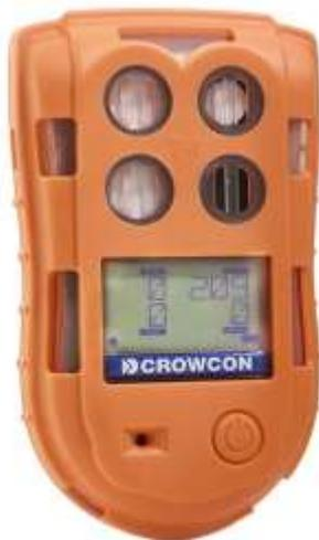
Detector portátil multigas con características de seguridad y un diseño intuitivo y robusto que proporciona una protección avanzada en entornos severos y frente a un amplio rango de gases que se manejan en la industria.
