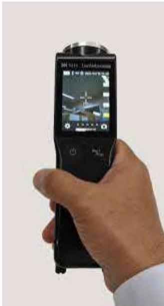
El LaserMethane Smart es un detector de gas metano compacto y portátil con una cámara para filmar un punto de inspección. Adecuado para aquellos que trabajan en áreas con sistemas de distribución de gas, almacenamiento subterráneo de gas, estación de distribución de gas, planta de procesamiento de gas, compresión de gas y almacenamiento de gas.
