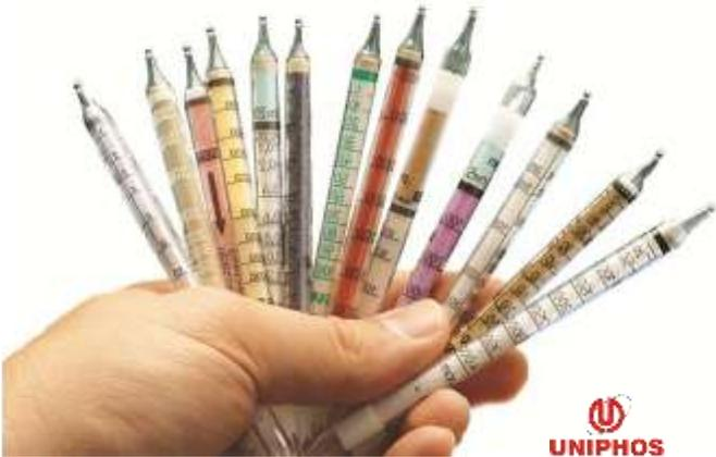
Los tubos detectores químicos de diferentes fabricantes trabajan en el mismo principio y utilizan productos químicos sensores similares o similares para detectar la concentración de gas objetivo Sin embargo, las dimensiones físicas de los tubos y el diseño de la bomba para extraer los 100 ml de aire de muestra requeridos varían de un fabricante a otro
