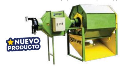
Secadora rotativa de café armable con una novedosa tecnología alemana en ventilación que permite un flujo de aire variable para las diferentes etapas del secado. Además, cuenta con un sistema de transmisión silenciosa por cadena que disminuye las vibraciones.
