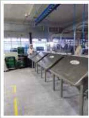
Uno de los formatos utilizados en el manejo de sólidos son los sacos que llegan a un peso máximo de 50 KG para su manipulación en planta. TOT cuenta con estación de descarga de sacos versátiles y flexibles de usar gracias a su estructura modular. Es posible configurar la estación para descarga sacos combinados con descarga de Big Bag. Nuestro equipo es compacto, cuenta con diseño higiénico, manejo ergonómico y libre de polvo.
