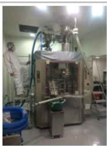
LOS SISTEMAS DE TRANSPORTE NEUMÁTICO POR VACÍO SON IDEALES CUANDO SE TIENEN VARIOS PUNTOS DE ORIGEN Y UN SOLO PUNTO DE DESTINO.
