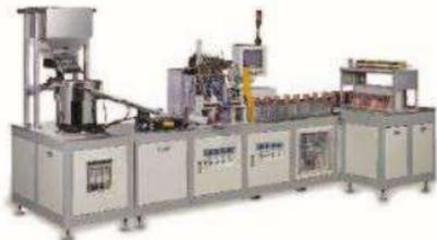
COLOCADORA AUTOMÁTICA DE VÁLVULAS TIPO POUCH LARGAS
