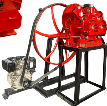
Trapiche R2S, Motor Diesel 10 Hp, estructura de apoyo.
