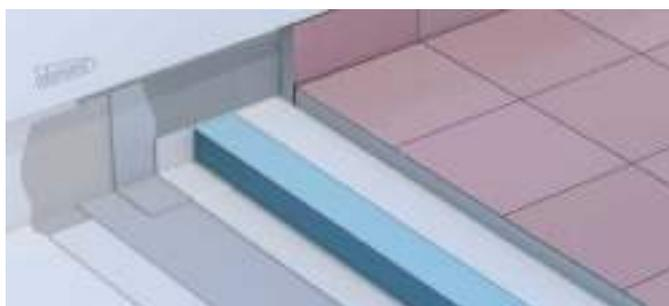
**Soporte + Impermeabilización + Aislamiento + Mortero de protección + Acabado final**
