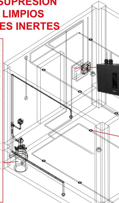
EL DETECTOR DE HUMO ÓPTICO es la manera más eficaz de detectar un incendio en su fase incipiente. Permite tomar medidas para controlar el fuego, facilitar la evacuación y actuar sobre el sistema de extinción. Estos detectores detectan los humos visibles mediante la absorción o difusión de la luz.
